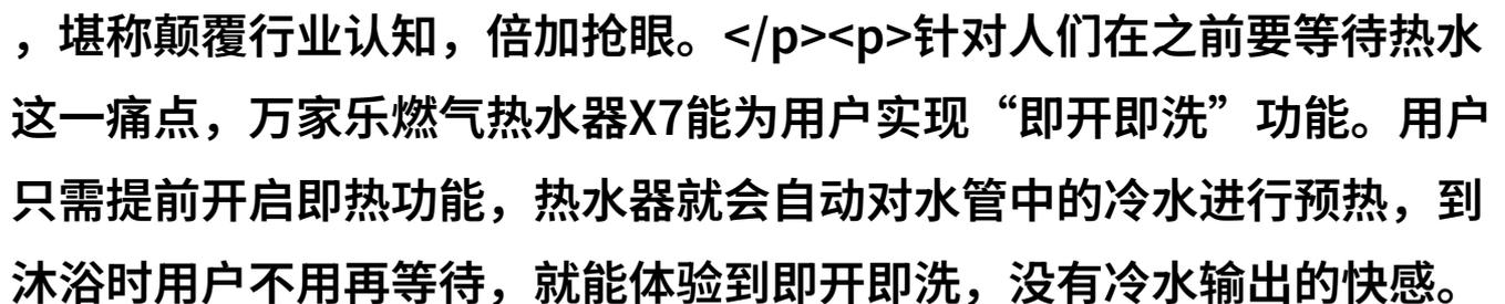
现如今的互联网+在万家乐X7上也有显著体现。万家乐燃气热水器X7的“WiFi预约”功能可以帮助用户实现即使不在家也能提前预热。用户可设定预热启动的时间段、预热的水温和预热水温差，热水器就会根据设置在规定时间内自动完成预热任务。除此之外，用户使用无线WiFi技术，随时随地实现手机远程控制热水器，并能实时监控热水器的运作状态。
